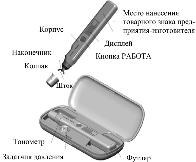
Рисунок 1 – Внешний вид тонометра ТГДц-03
