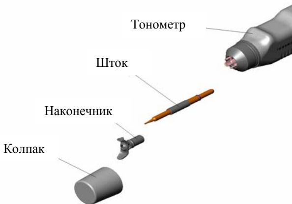
Рисунок 2 – Подготовка тонометра к очистке штокового механизма
