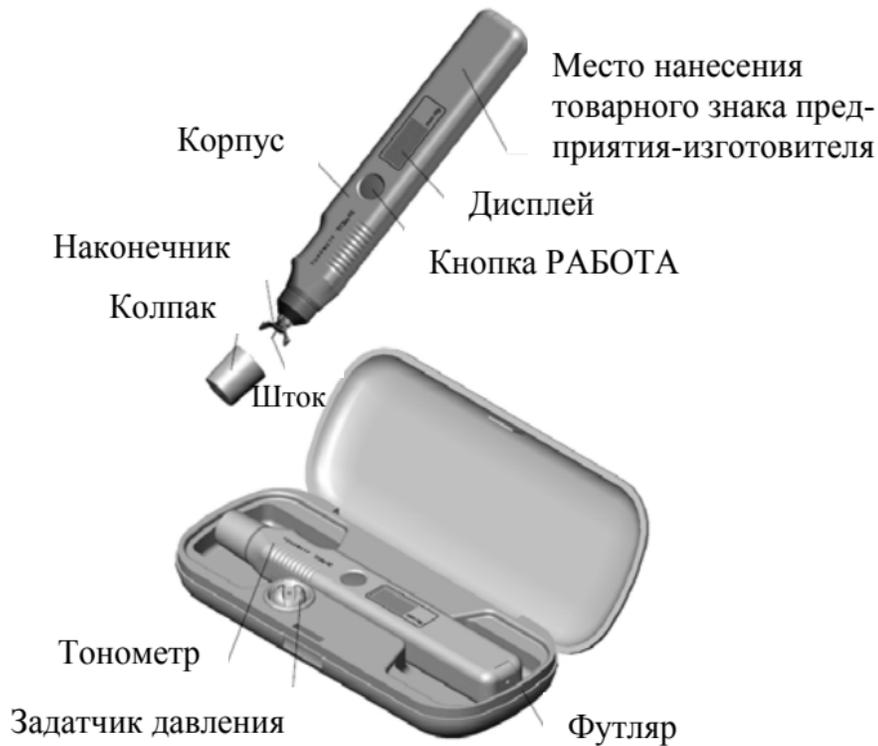
Рисунок 1 – Внешний вид тонометра ТГДц-03
