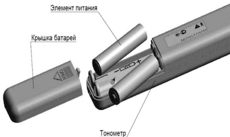
Рисунок 2 – Установка элементов питания
