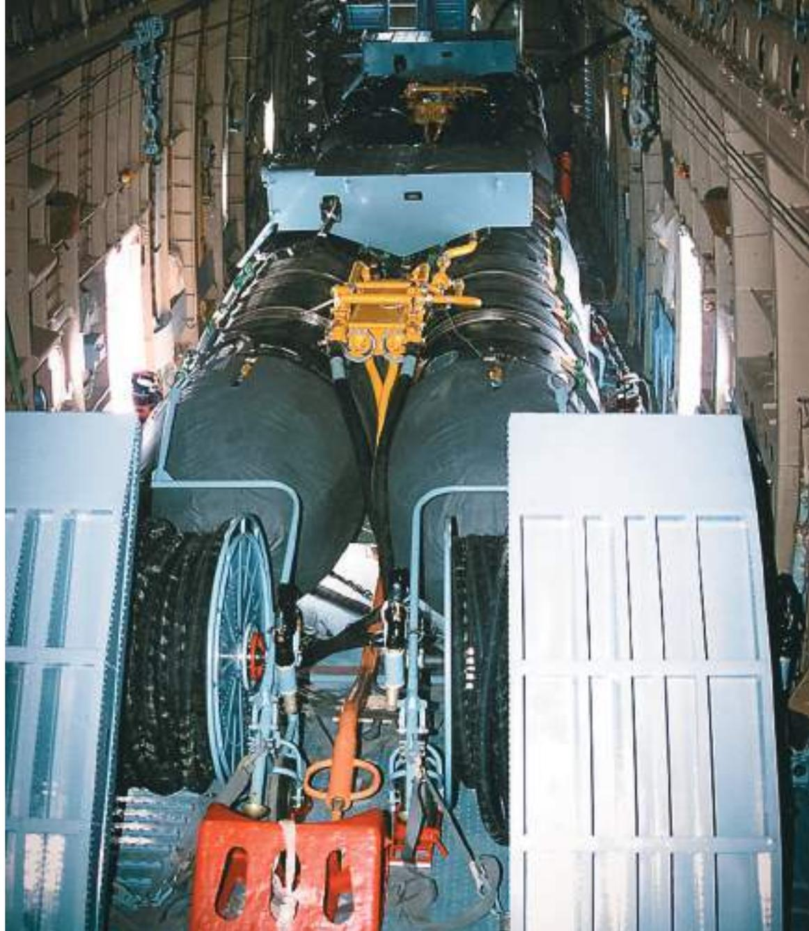
Топливозаправочный вариант вертолета создан для оперативной доставки и раздачи топлива, а также смазочных материалов в места базирования техники. Вертолет оборудуется топливозаправочным оборудованием в двух вариантах – для транспортировки и раздачи авиационного топлива для самолетов и вертолетов, для транспортировки и раздачи дизельного топлива и смазочных материалов для наземной техники.
