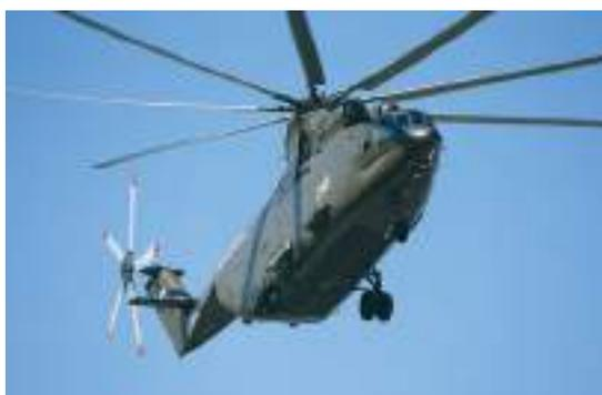
Вертолет Ми-26Т2 обладает непревзойденной грузоподъемностью и предназначен для перевозки техники и крупногабаритных грузов весом до 20 тонн в грузовой кабине или на внешней подвеске.
