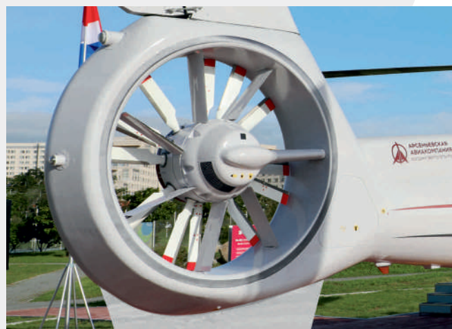
12-лопастной рулевой винт в кольцевом канале
