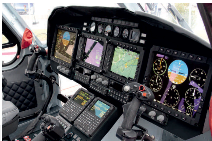
Комплекс бортового оборудования, построенный по принципу «Стеклянной кабины»
