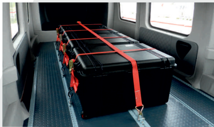
Расположение элементов крепления грузов и оборудования на полу
